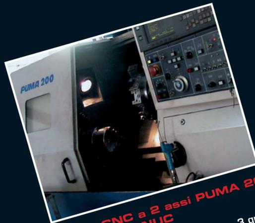
**Tornio CNC a 2 assi PUMA 200LC con CNC FANUC**
