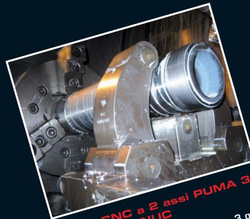
**Tornio CNC a 2 assi PUMA 350B con CNC FANUC**
