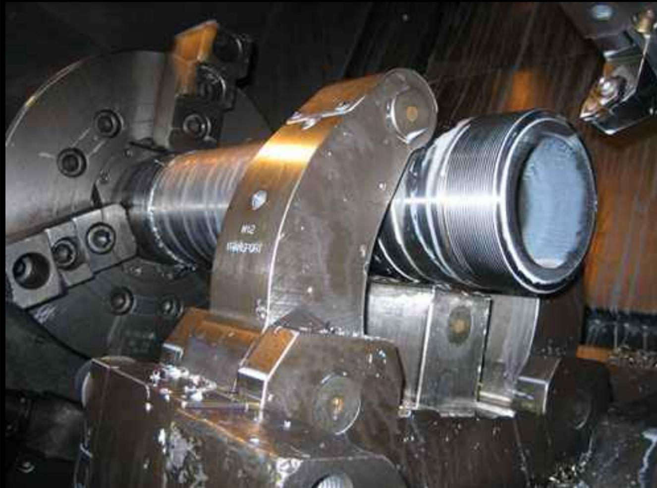
**Tornio CNC a 2 assi PUMA 350B con CNC FANUC**
